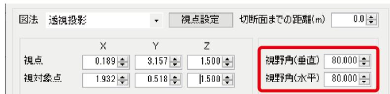
全方位画像では、鉛直 180 度・水平 180 度の半球画像 2 画を合成して全球画像とします。その都合上、全方位の視野角の設定値は、鉛直・水平ともに緩衝分を含む 200~220 度としてください。
